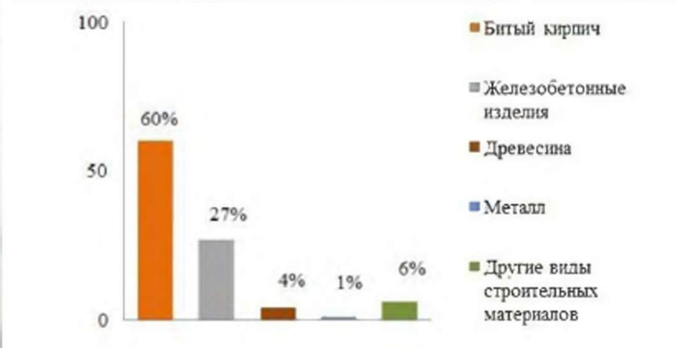
Кирпич и железобетонные изделия лежат в основе самого здания. Древесина, металл и остальное являются дополнительными, поэтому их значительно меньше.
